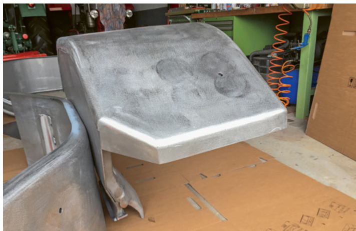
Die neuen Kotflügel für den D200s; die Breite ist der neuen Bereifung angepasst.
